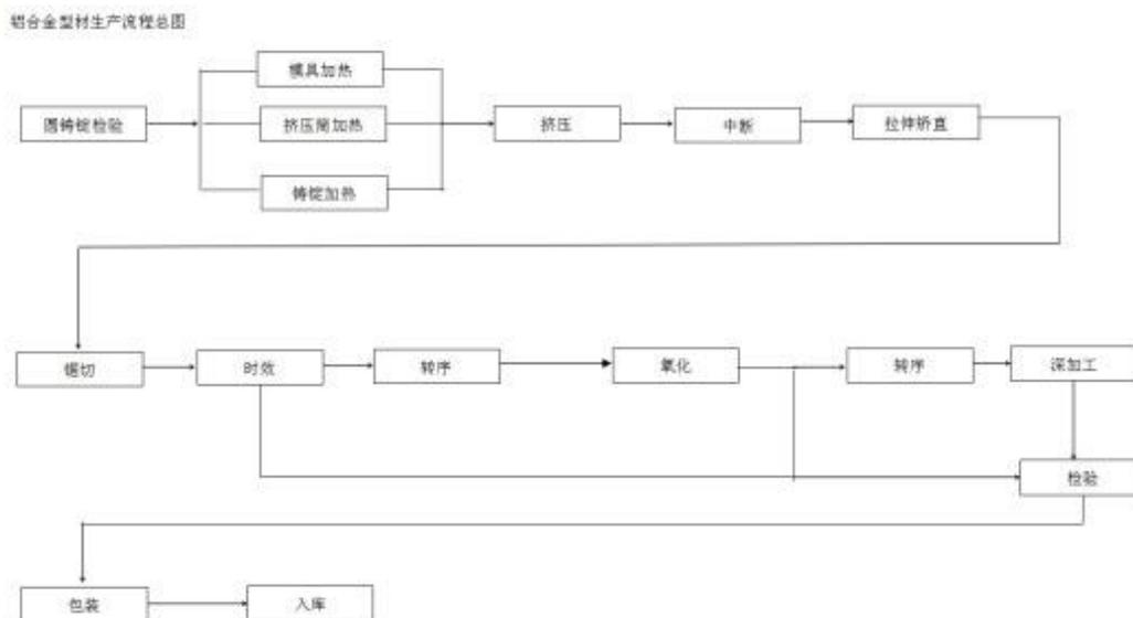
图 1-3 铝合金型材工艺流程图
